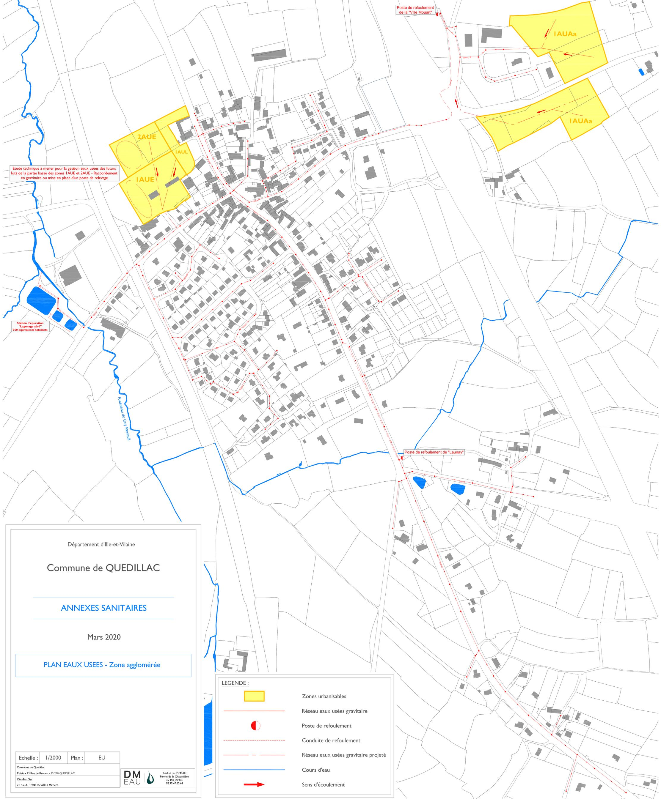
Etude technique à mener pour la gestion eaux usées des futurs lots de la partie basse des zones IAUE et 2AUE - Raccordement en gravitaire ou mise en place d'un poste de relevage
