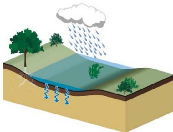
Figure - Noue engazonnée et plantée infiltrante.
